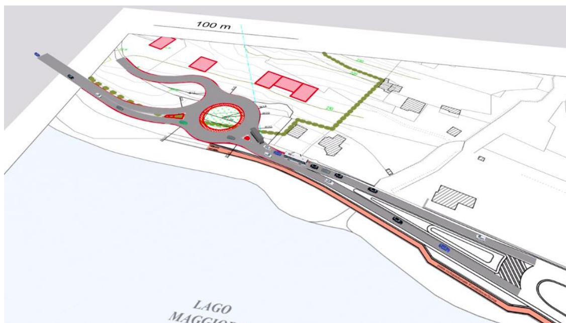
Alcuni frame estratti dalla micro simulazione condotta durante l'ora di punta (17.00-18.00).
