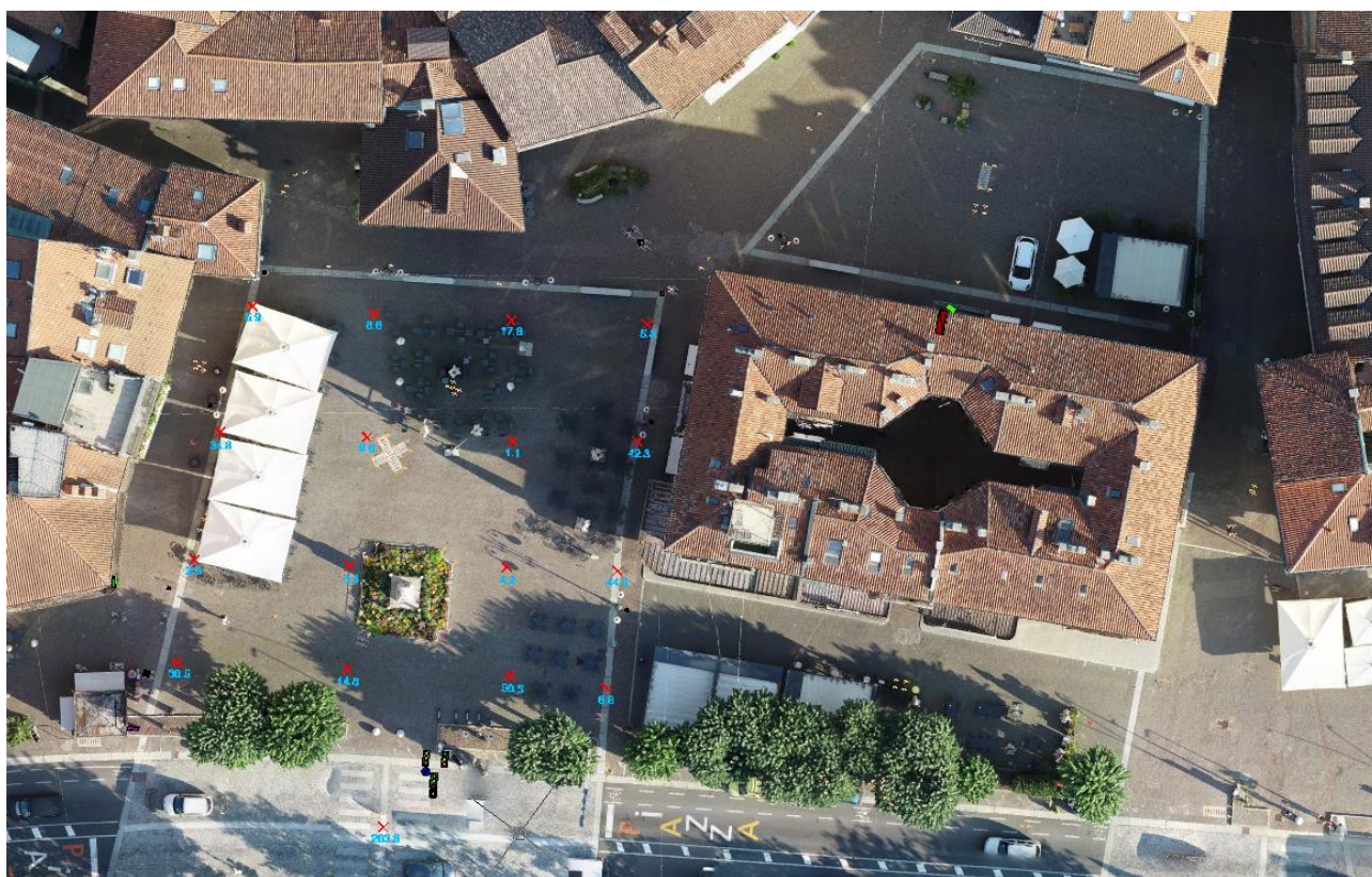
Figura: punti di calcolo scelti per la rappresentazione ideale di una griglia di rilievo fotometrico. I punti sono rappresentati dalla croce rossa, mentre il sottostante numero è il valore di illuminamento medio rilevato per quel punto
