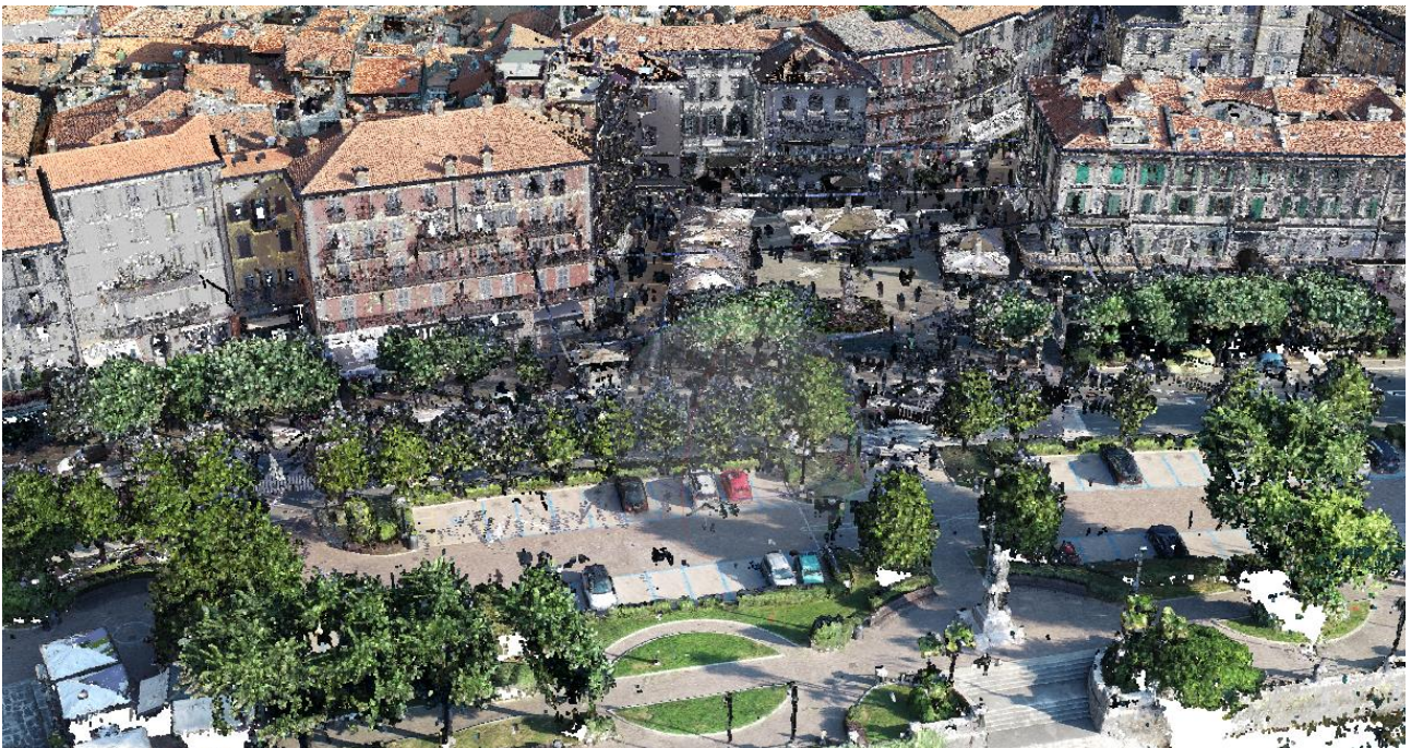
Figura: Nuvola di punti 3D laser scanner unita a nuvola di punti 3D aerofotogrammetria
