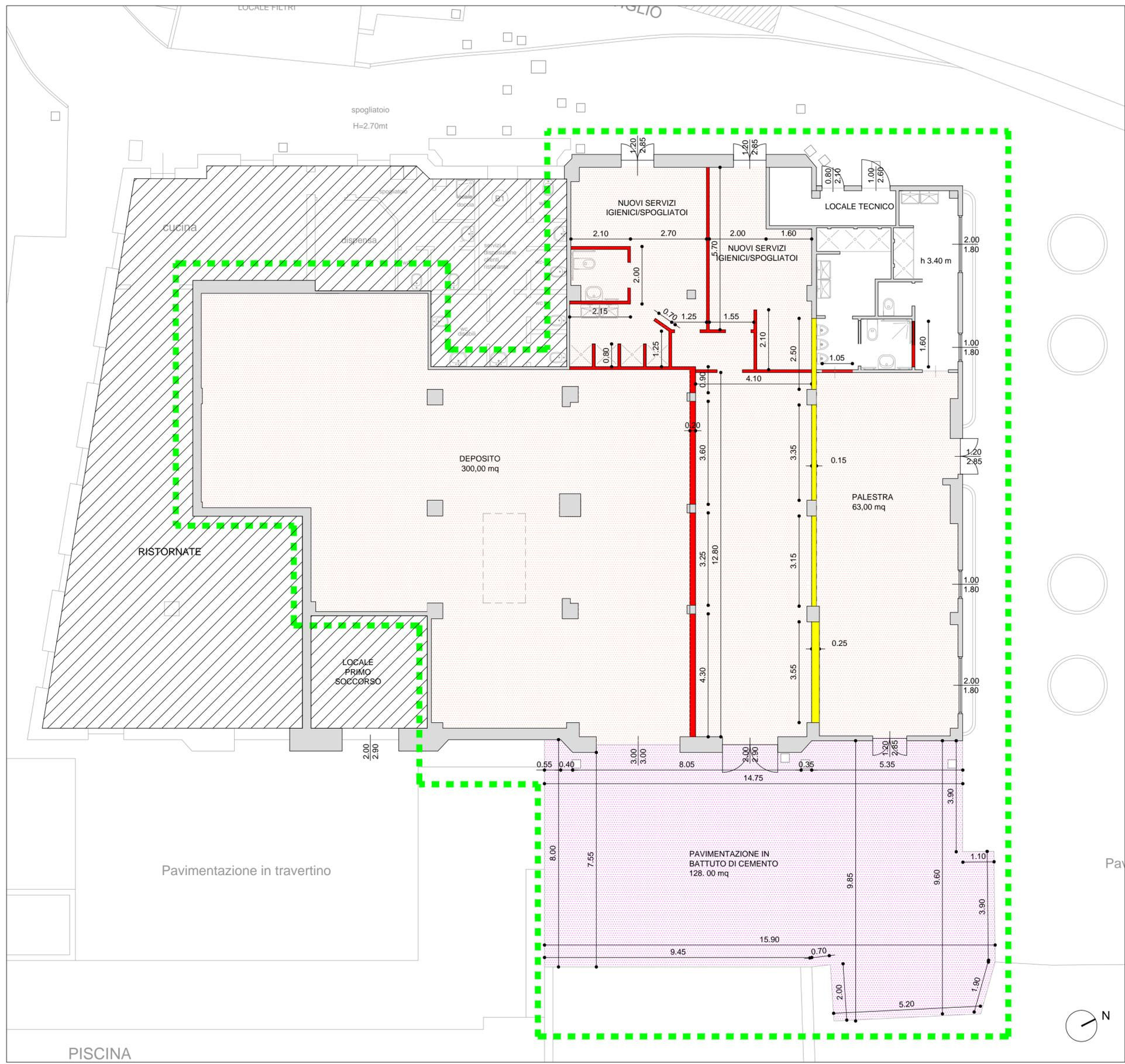
PIANTA DEMOLIZIONI E RISCOTRUZIONI
