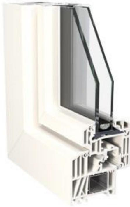
**FIG. 23:SEZIONE DI UN SERRAMENTO TIPO IN PVC**
