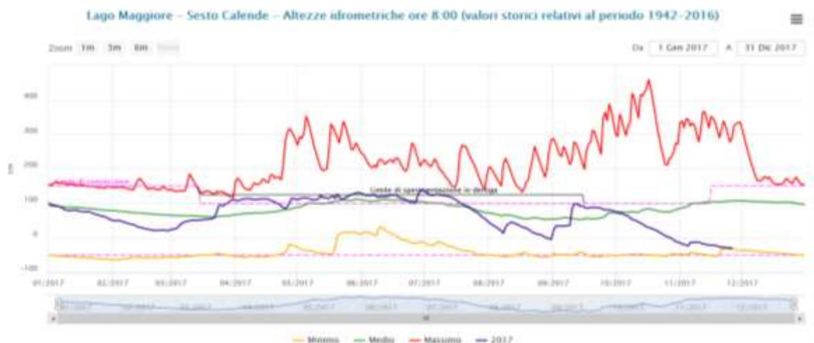
*Altezze idrometriche giornaliere nella serie 1942-2016 rilevate con riferimento allo 0 idrometrico a 193.00 mslm con indicazione minimo e massimo storico, valore medio e valore rilevato nel 2017, oltre ad indicazione del limite di concessione e del limite di sperimentazione in deroga*
