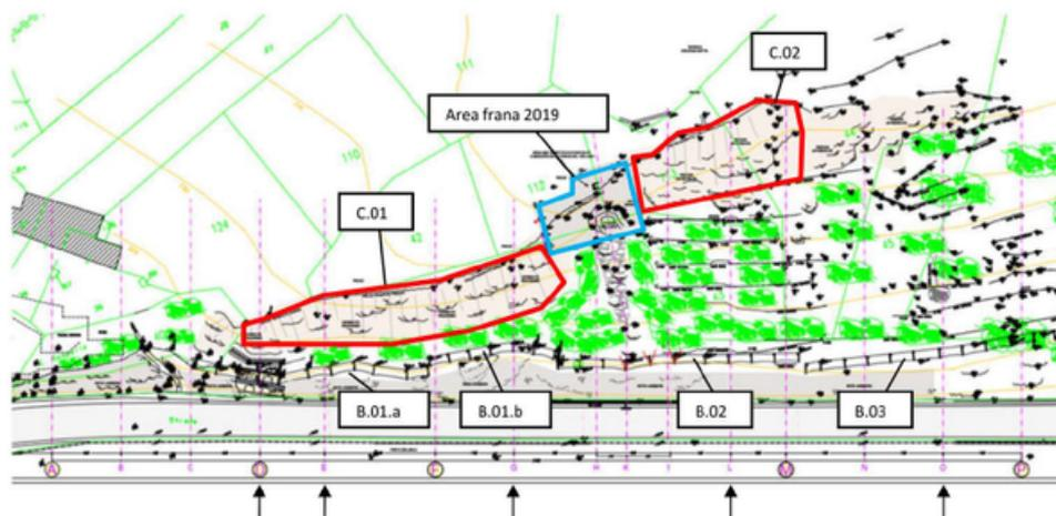
Planimetria dell'area di intervento con indicazione dei settori di falesia oggetto di intervento di consolidamento corticale e delle tratte barriere paramassi esistenti
